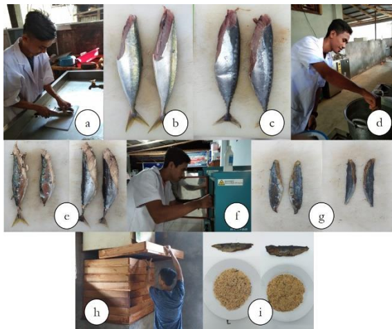
Gambar 2. Proses pembuatan ikan kayu. (a) preparasi; (b) ikan layang; (c) ikan tongkol; (d) perebusan; (e) hasil perebusan; (f) pengeringan; (g) hasil pengeringan; (h) pengasapan; (i) hasil pengasapan.
