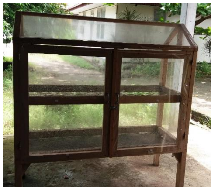
Gambar 12. Solar dryer Pembandingan
