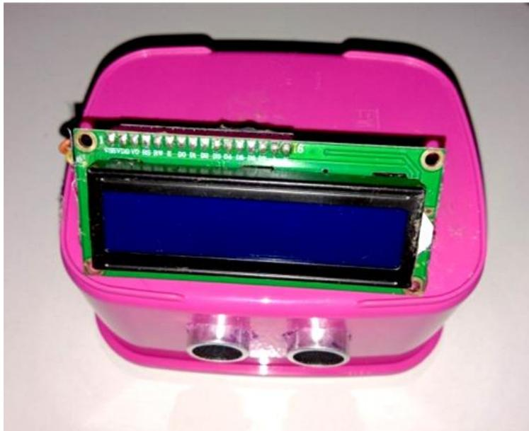
**Gambar 1.** Alat praktikum menggunakan sensor ultrasonik dikombinasikan dengan arduino.
