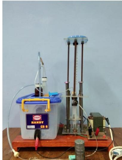
**Gambar 3.** Tampilan alat peraga elektroliser sederhana
