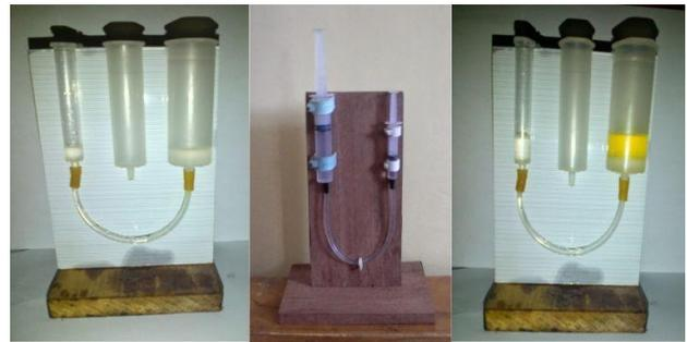
**Gambar 5.** Alat Peraga Fisika Pompa hidrolis Sederhana
