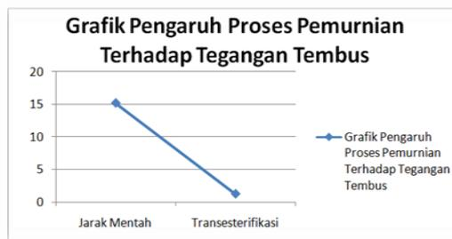
Gambar 7. Grafik Hasil Pengujian Tegangan Tembus
