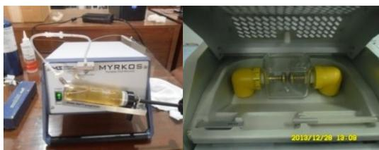
Gambar 2. Alat Uji Kandungan Gas dan Tegangan Tembus
