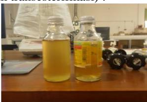
Gambar 3. Minyak Jarak Mentah dan Minyak Jarak Hasil Transesterifikasi
