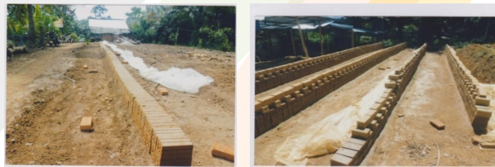
Gambar 3.6. Penjemuran hasil cetakan Tanah Liat Merah menjadi Batu Bata
