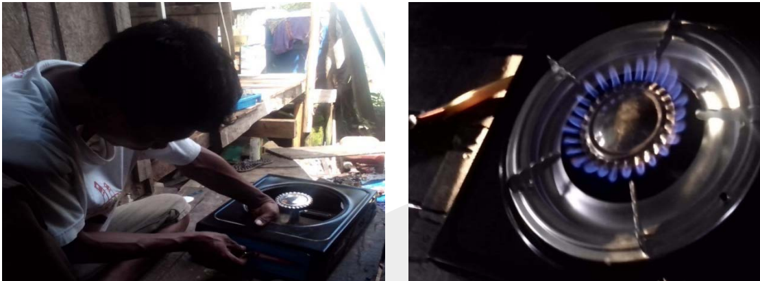
Gambar 4. Modifikasi kompor dan kompor yang menyala dari biogas enceng gondok
