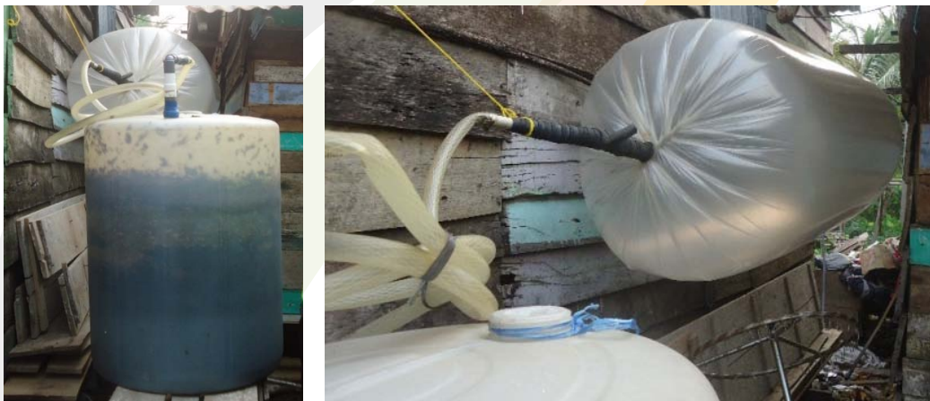
Gambar 3. Tempat penampung gas yang sudah terisi penuh
