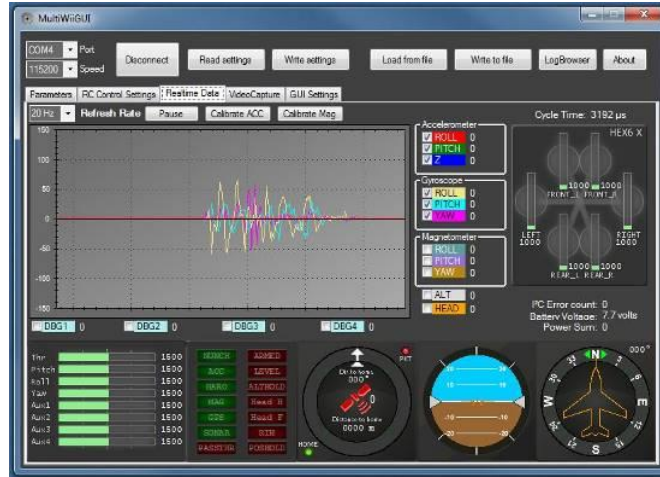
Gambar 3.4 Pembacaan real-time data sensor pada drone pada software GUI
