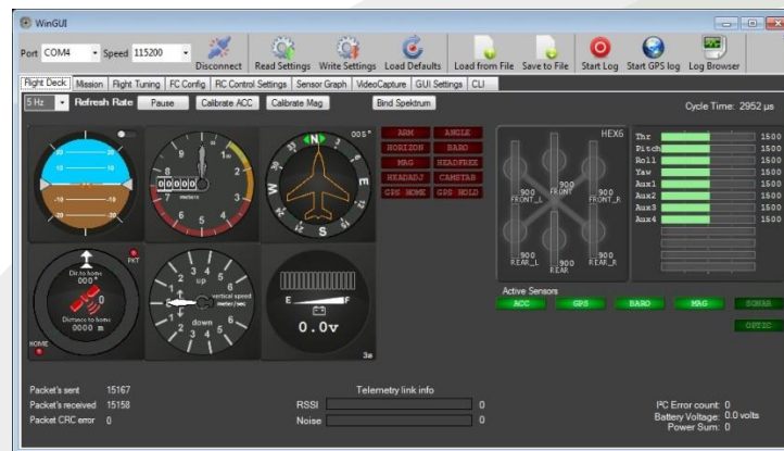
Gambar 3.3 Tampilan GUI mengenai informasi flight data dari UAV
