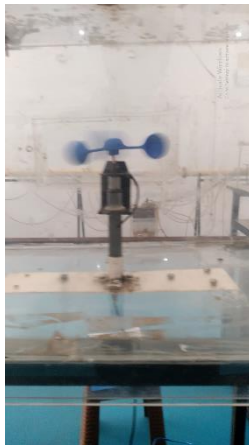
Gambar 5 Pengujian anemometer rancangan
