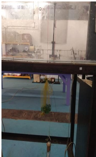
Gambar 10 Turbin Darrieus pada saat berputar
