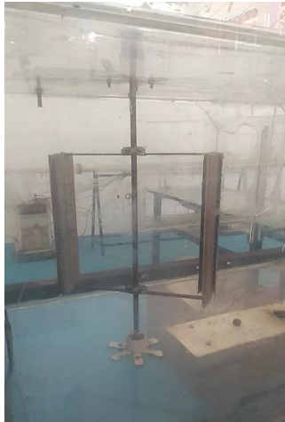
Gambar 9 Turbin Darrieus pada saat dipasang
