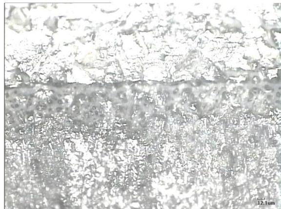
**Gambar 21** Daerah Lasan, HAZ, Dan Logam Induk TIG 90A
