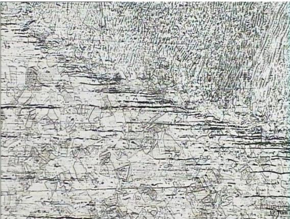
**Gambar 18** Daerah Lasan, HAZ, Dan Logam Induk SMAW 120A
