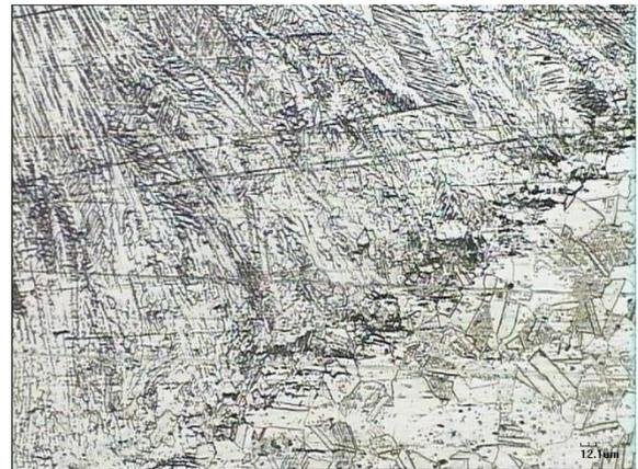
**Gambar 27** Daerah Lasan, HAZ, Dan Logam Induk TIG 120A
