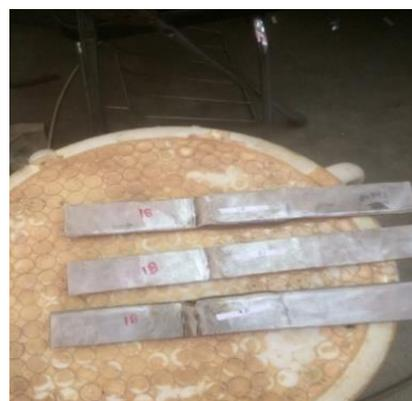
**Gambar 3** Spesimen Uji bending
