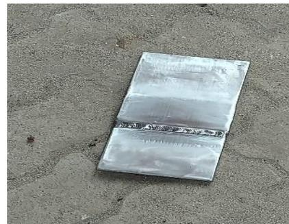
**Gambar 2** Spesimen Uji Makro dan *Dye Penetrant*.
