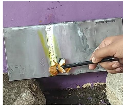
**Gambar 6** Proses Pengujian Makro
