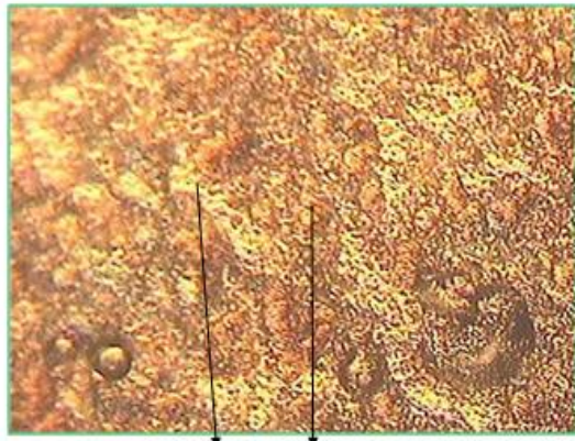
Gambar 10. Struktur Mikro batang besi pejal KSJI Ø 12 mm yang tidak mengalami Pembakaran dengan Perbesaran 40x
