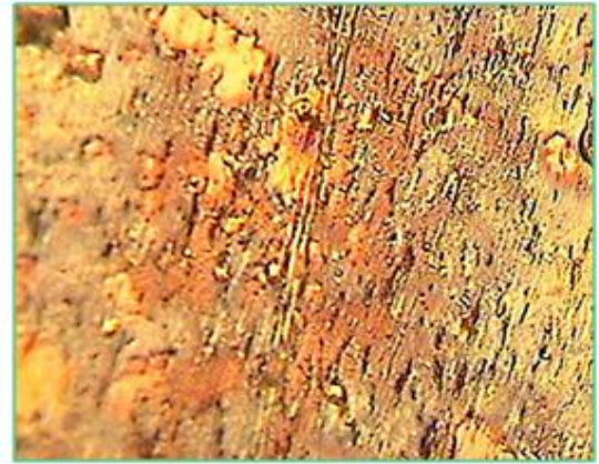
Gambar 12. Struktur Mikro batang besi pejal KSJI Ø 10 mm yang mengalami Pembakaran dengan Perbesaran 40x
