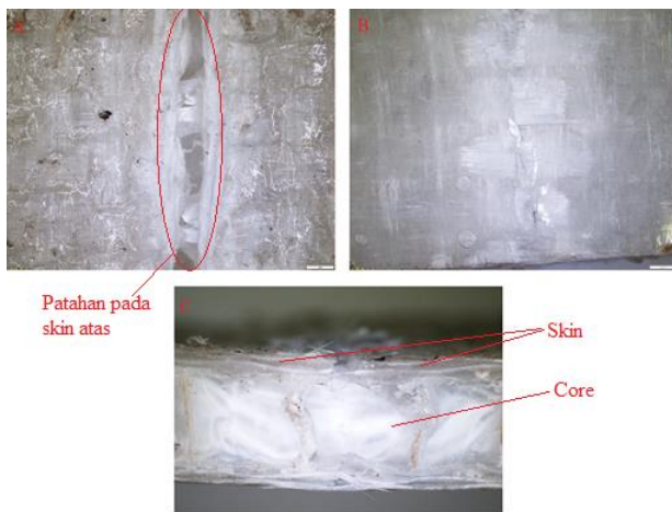
Gambar 8. Hasil Foto Makro Skin 2 Lapis Perbesaran 67x Hasil Foto Makro Pengujian Tarik Komposit Sandwich Variasi Skin 2 Lapis
