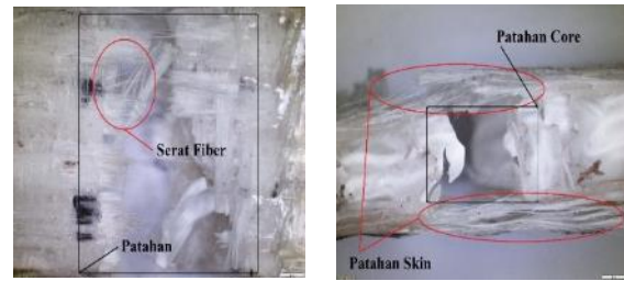
(a) Tampak Depan (b) Tampak Samping
