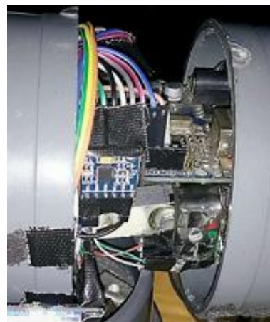
Gambar 5. Integrasi sistem pada prototipe sensor torsi.
