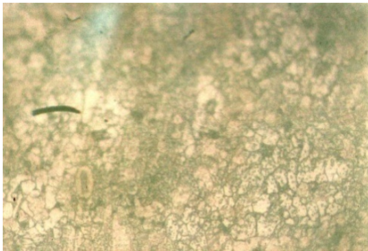
Gambar 20: Daerah HAZ Spesimen dengan arus 100 A dan kecepatan 0,25 cm/dtk
