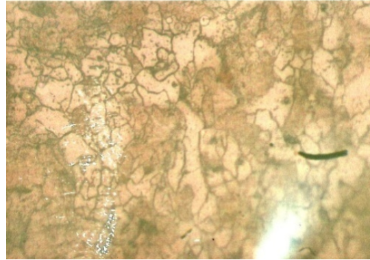
Gambar 15: Daerah HAZ Spesimen dengan arus 100 A dan kecepatan 0,37 cm/dtk
