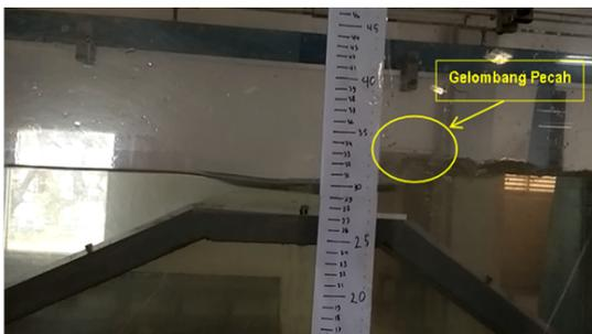
Gambar 4. Gelombang Pecah di atas Struktur *Submerged Breakwater*
