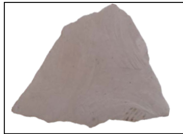
Gambar 3. Batu gamping C Dengan Karakteristik Fisik Lembut Mudah Hancur
