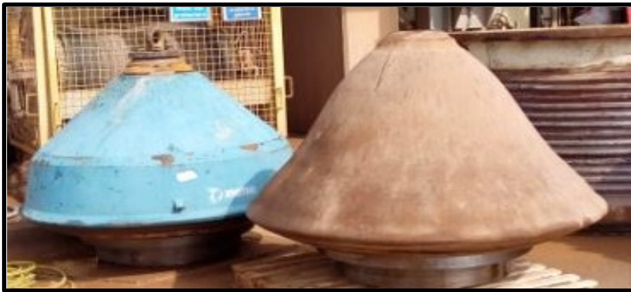
Gambar 2. Mantle kondisi baru (kiri) dan mantle kondisi aus (kiri)
