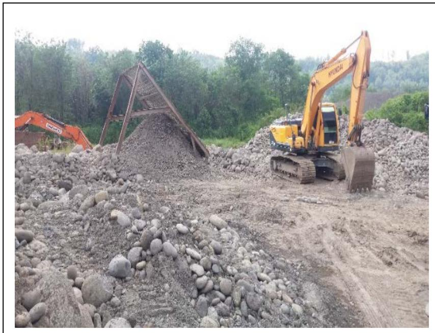
**Gambar 1. Penambangan Pasir Sungai Lematang secara Mekanis**
