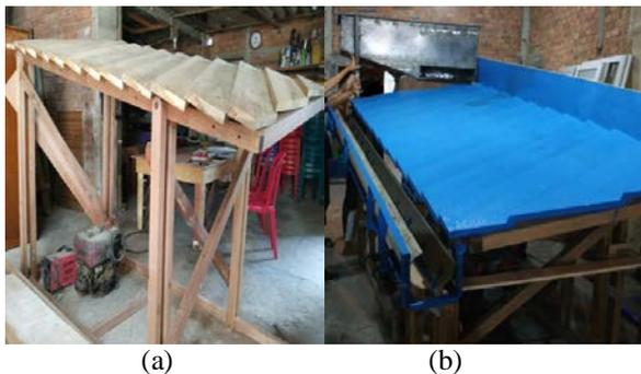
**Gambar 3.** Rancangan alat pencucian pasir (a)sebelum (b). sesudah.
