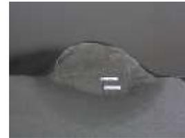
Gambar 10 Kedalaman Penetrasi 1.3 ketika arus 70 A
