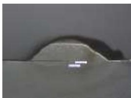
Gambar 33 Kedalaman Penetrasi 2.3 ketika arus 60 A
