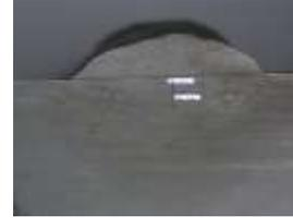
Gambar 24 Kedalaman Penetrasi 1.6 ketika arus 90 A
