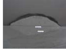
Gambar 8 Kedalaman Penetrasi 1.2 ketika arus 90 A
