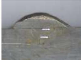
Gambar 47 Kedalaman Penetrasi 2.6 ketika arus 68 A
