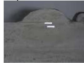
Gambar 30 Kedalaman Penetrasi 2.2 ketika arus 70 A
