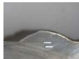
Gambar 44 Kedalaman Penetrasi 2.5 ketika arus 90 A
