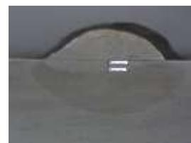
Gambar 26 Kedalaman Penetrasi 2.1 ketika arus 70 A
