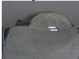
Gambar 9 Kedalaman Penetrasi 1.3 ketika arus 60 A
