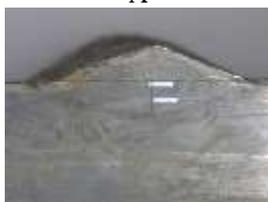
Gambar 43 Kedalaman Penetrasi 2.5 ketika arus 80
