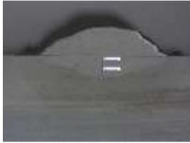
Gambar 39 Kedalaman Penetrasi 2.4 ketika arus 80 A
