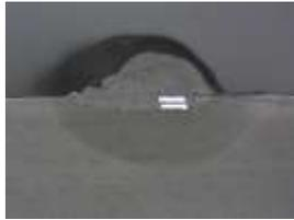
Gambar 21 Kedalaman Penetrasi 1.6 ketika arus 60 A
