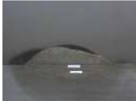
Gambar 15 Kedalaman Penetrasi 1.4 ketika arus 80 A
