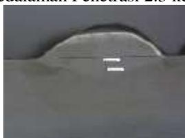
Gambar 35 Kedalaman Penetrasi 2.3 ketika arus 80 A
