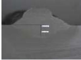
Gambar 7 Kedalaman Penetrasi 1.2 ketika arus 80 A
