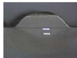
Gambar 34 Kedalaman Penetrasi 2.3 ketika arus 70 A
