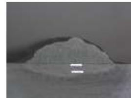
Gambar 12 Kedalaman Penetrasi 1.3 ketika arus 90 A
