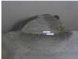
Gambar 13 Kedalaman Penetrasi 1.4 ketika arus 60 A
