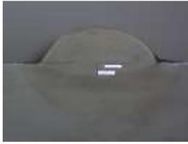
Gambar 37 Kedalaman Penetrasi 2.4 ketika arus 60 A
