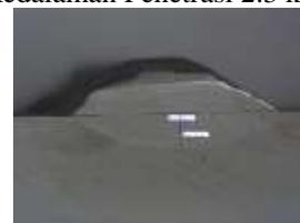
Gambar 36 Kedalaman Penetrasi 2.3 ketika arus 90 A
