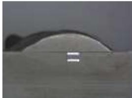
Gambar 27 Kedalaman Penetrasi 2.1 ketika arus 80 A
