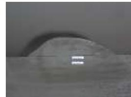
Gambar 20 Kedalaman Penetrasi 1.5 ketika arus 90 A
