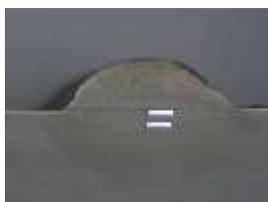
Gambar 25 Kedalaman Penetrasi 2.1 ketika arus 60 A
