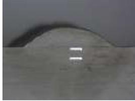
Gambar 23 Kedalaman Penetrasi 1.6 ketika arus 80 A
