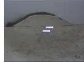
Gambar 32 Kedalaman Penetrasi 2.2 ketika arus 90 A
