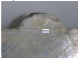
Gambar 41 Kedalaman Penetrasi 2.5 ketika arus 60
