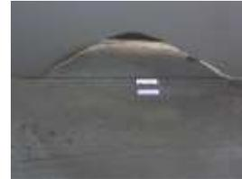
Gambar 16 Kedalaman Penetrasi 1.4 ketika arus 90 A
