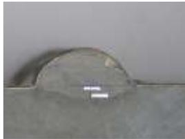
Gambar 45 Kedalaman Penetrasi 2.6 ketika arus 60 A
