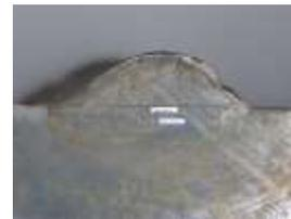
Gambar 42 Kedalaman Penetrasi 2.5 ketika arus 70 A
