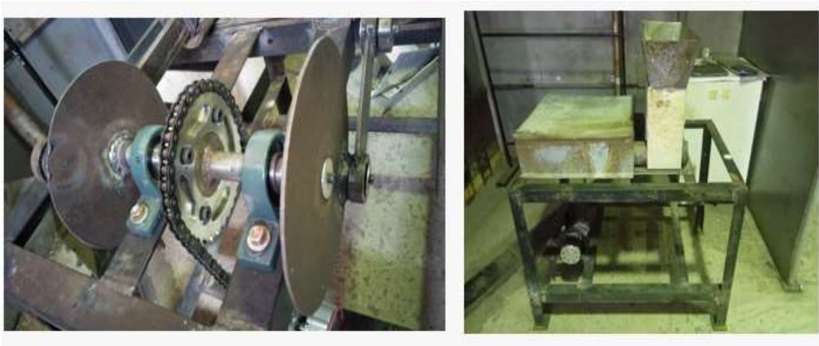
Gambar 5. Hasil rancang bangun Spesifikasi mesin yang dibuat adalah panjang 100 cm, lebar 70 cm, dan tinggi 116 Cm
