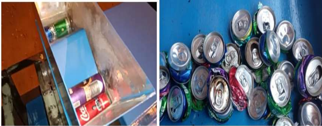
Gambar 6. Posisi kaleng dalam hopper dan hasil pengepresan
