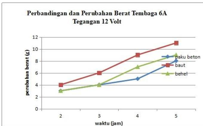
Gambar 5. Grafik Perbedaan Perubahan Berat Antar Paku, Beton, Baut, Behel Pada Pelapis Timah Dengan Tegangan Arus Listrik 6 Ampere Dengan Tegangan 12 Volt.
