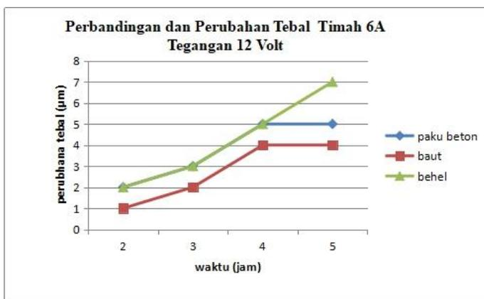
Gambar 6. Grafik Perbedaan Perubahan Tebal Antar Paku, Beton, Baut, Behel Pada Pelapis Timah Dengan Tegangan Arus Listrik 6 Ampere Dengan Tegangan 12 Volt.
