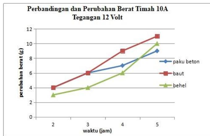
Gambar 3. Grafik Perbedaan Perubahan Berat Antar Paku, Beton, Baut, Behel Pada Pelapis Timah Dengan Tegangan Arus Listrik 10 Ampere Dengan Tegangan 12 Volt.
